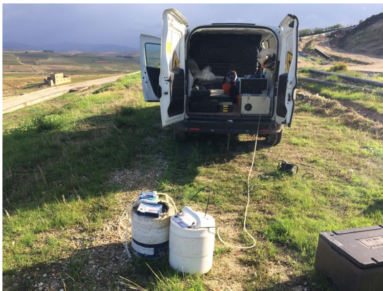
Figura 26 - Monitoraggio emissioni diffuse Vasca G e H
