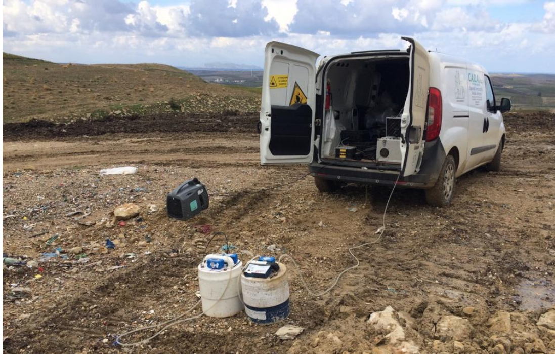
Figura 25 - Monitoraggio emissioni diffuse Vasca F (punto identificato E5)
